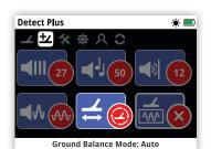
La fonction « Compensation des effets de sol » est disponible sur la page « Detect Plus ». La fonction « Compensation des effets de sol » comporte trois paramètres possibles selon le type de terrain.
