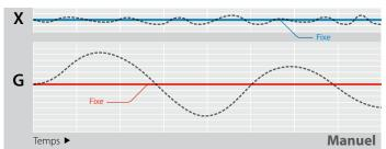
Le mode « Manuel » est déconseillé, sauf pour un utilisateur averti du GPZ 7000 et si le terrain est homogène (les conditions de terrain ne sont pas hautement variables).
