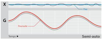
Le mode « Semi-auto » est utile pour les utilisateurs expérimentés. Le mode « Semi-auto » fixe X et peut éliminer de faibles murmures audio pour renvoyer un signal stable plus harmonieux tout en continuant de suivre G.
